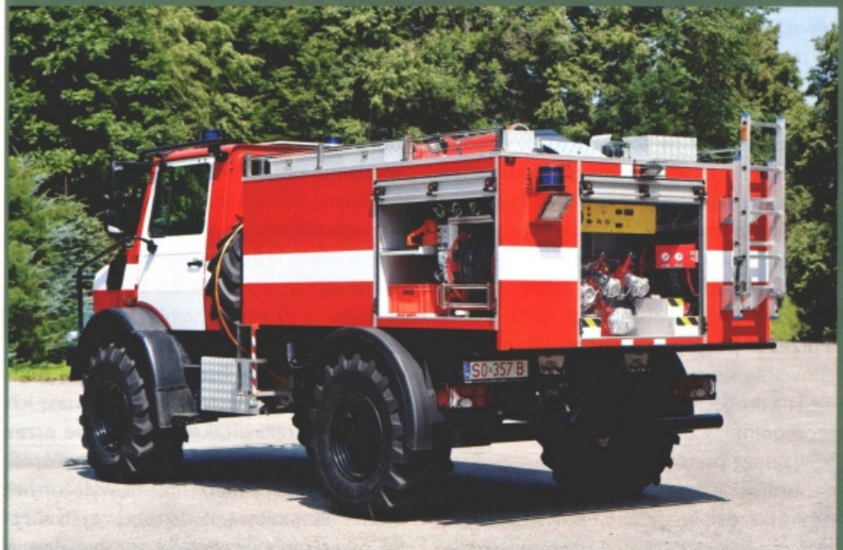
Kompaktowa zabudowa nawet wraz z umieszczonymi na dachu skrzyniami nie wystaje ponad obrys dachu kabiny. Zbiornik na wodę ma pojemność 2500 l. Jego konstrukcja oraz przedziału autopompy firmy Godiva tworzą jedną całość.
