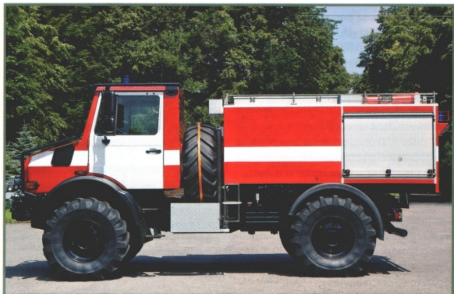
Zwarte wymiary ułatwiają manewrowanie między drzewami i innymi przeszkodami terenowymi.
