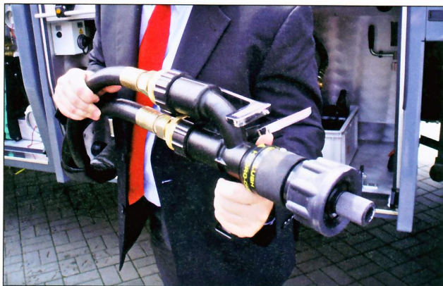
Prądownica z dyszą „hydrochem” do jednoczesnego podawania piany i proszku gaśniczego
