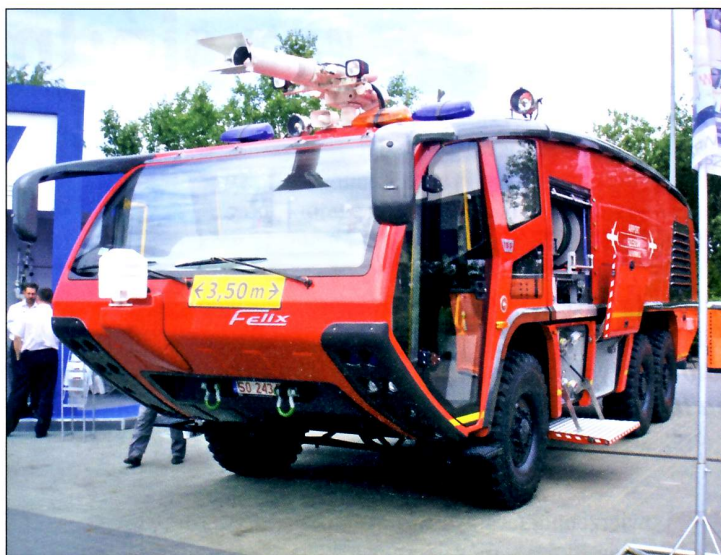
Ciężki lotniskowy samochód ratowniczo-gaśniczy produkcji iSS Wawrzaszek – Felix 6x6 nagrodzony w kategorii pojazdów pożarniczych specjalnych
