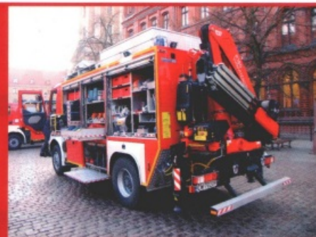
Z tyłu Keraksów zamontowano mocne żurawie hydrauliczne.
