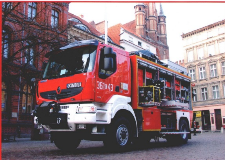
W ramach programu dziewięć jednostek ratowniczo-gaśniczych PSP wzbogaciło się o takie nowoczesne ciężkie pojazdy ratownictwa technicznego zbudowane na podwoziu Renault Kerax z układem napędowym 4x4
