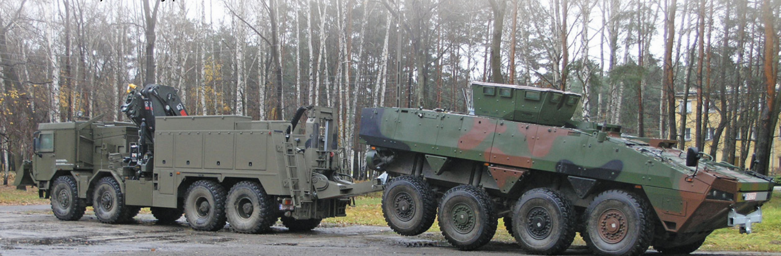
Holowanie tyłem uniesionego podwozia KTO Rosomak
