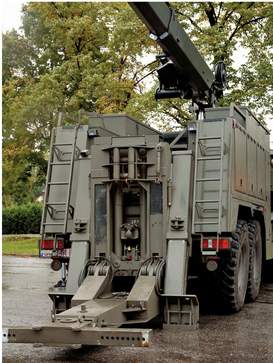
Szczegóły konstrukcji urządzenia do unoszenia i holowania uszkodzonej ciężkiej techniki kołowej
